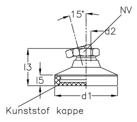
d1 = 40 d2 = 12 l3 = l5 = -NV = 17 Static load (N) = 16 t min = 11.5
